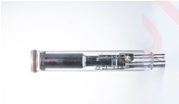
图6 成功研制的硅靶视像管
