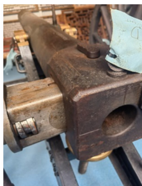
图1 宁局仿造的2门2磅弹克虏伯行营架退炮的侧视图、横楔式后膛以及炮身铭文
